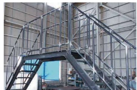
3次元レーザ加工機で加工された長尺パイプや形鋼を溶接した鉄製階段
