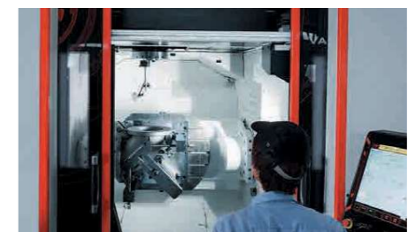
VARIAXIS i-800による切削加工で外注していた加工の内製化を実現
